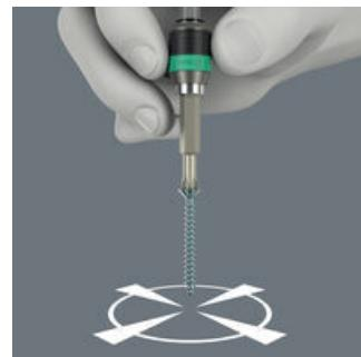
Die freilaufende Betätigunghülse erlaubt dem Anwender, den Akku- oder Elektroschrauber während des Schraubvorgangs an der Hülse zu führen. Das erleichtert das Ansetzen in der Schraube und verhindert Abrutschen. Auch als kurze Verlängerung bei 1/4" Anwendungen verwendbar z. B. in Kombination mit Wera Zyklop Knarren.
