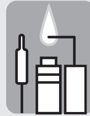
Abb. 4a: Wächterflamme brennt falsch
